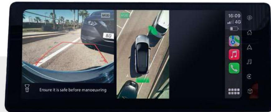
De la caméra unique de recul à l'écran à vue intelligente de surveillance à 360°, la technologie Nissan Intelligent Mobility vous permet de manœuvrer et de vous garer comme un pro, à chaque fois. La détection d'objets en mouvement alerte le conducteur par des avertissements sonores et visuels si un mouvement est détecté autour de votre véhicule.
